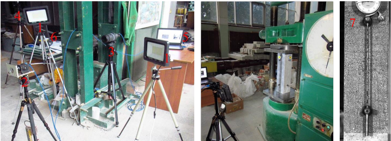
Рис. 2. Загальний вигляд дослідної установки випробування бетону: 1 – LED освітлення, 2 – камера з об'єктивом Computar F25/2.8, 3 – камера з об'єктивом Canon EF 70-200MM F/2.8 L IS III USM, 4 – камера для контролю навантаження, 5 – ноутбук для запису зображень, 6 – ноутбук для запису навантаження, 7 – дослідний зразок (вигляд з камери 2)
