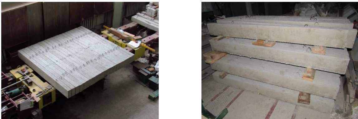
Рис. 6. Загальний вигляд дослідних зразків (залізобетонні балки)
