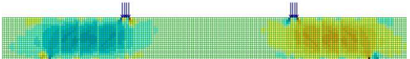
Ізополя дотичних напружень \tau_{xz} на бічній грані балки
