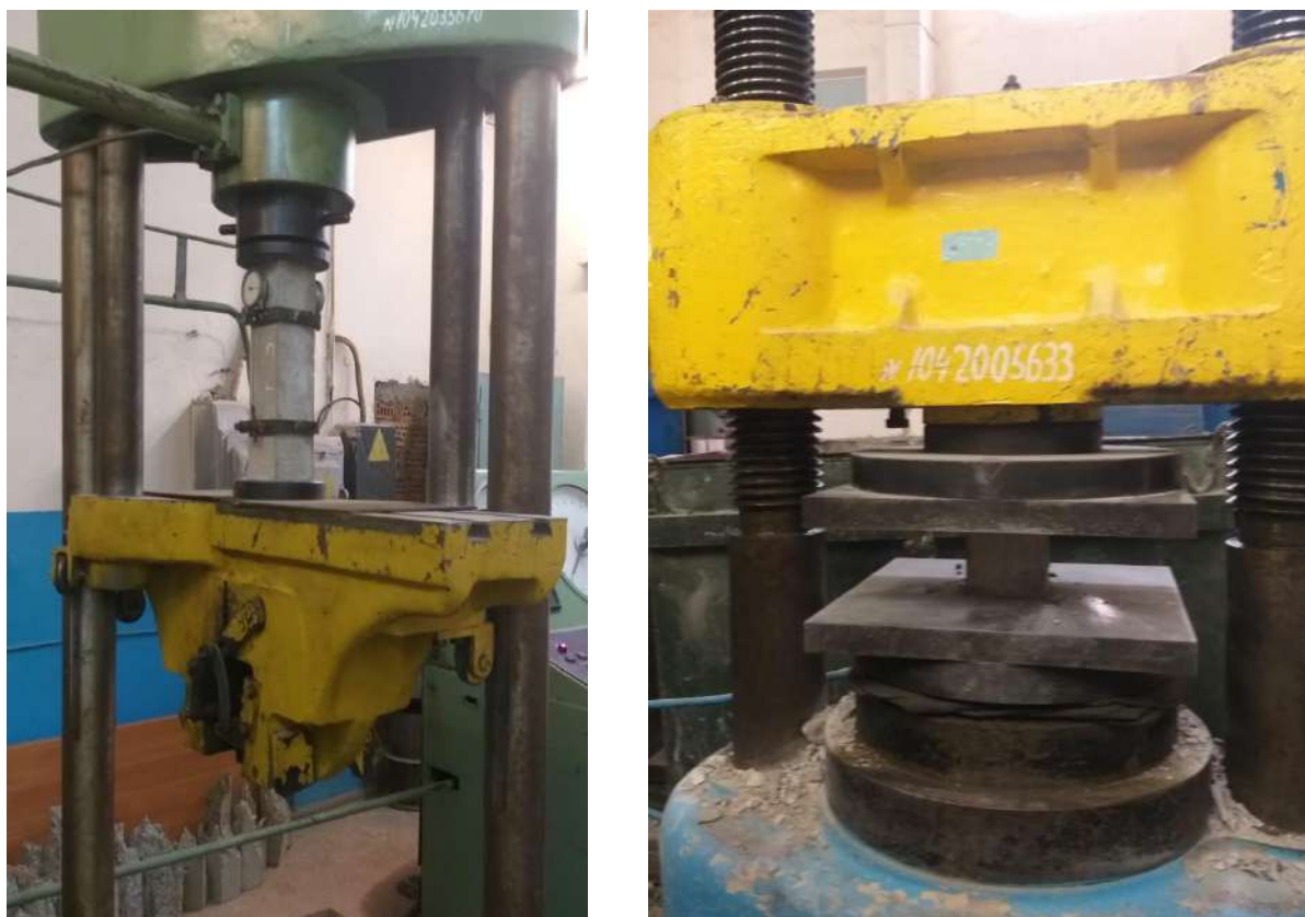
Рис. 2.7 Схеми випробування бетонних призм і кубів
