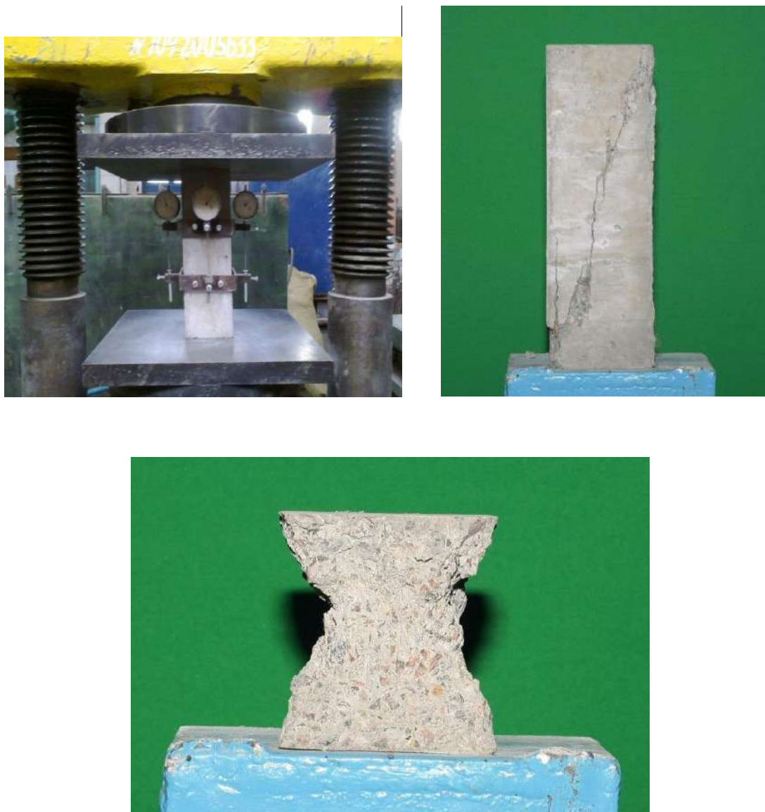
Рис. 2.7 Схеми випробування та характер руйнування бетонних призм і кубів
