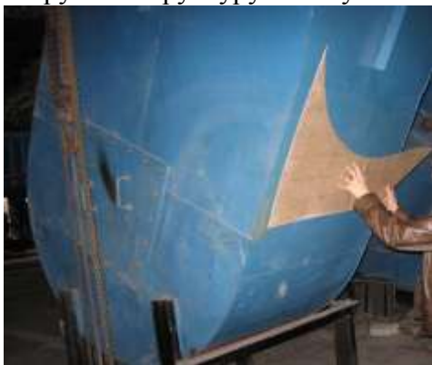
Рис.10. Монтаж вставок у вхідному патрубку вентилятора
