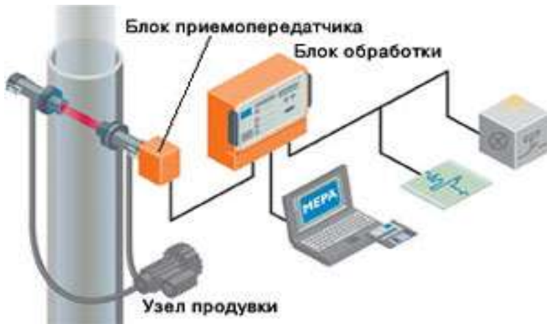
Рис. 6.3 Система автоматичного контролю фільтра РЦІ (викладено мовою оригіналу).
