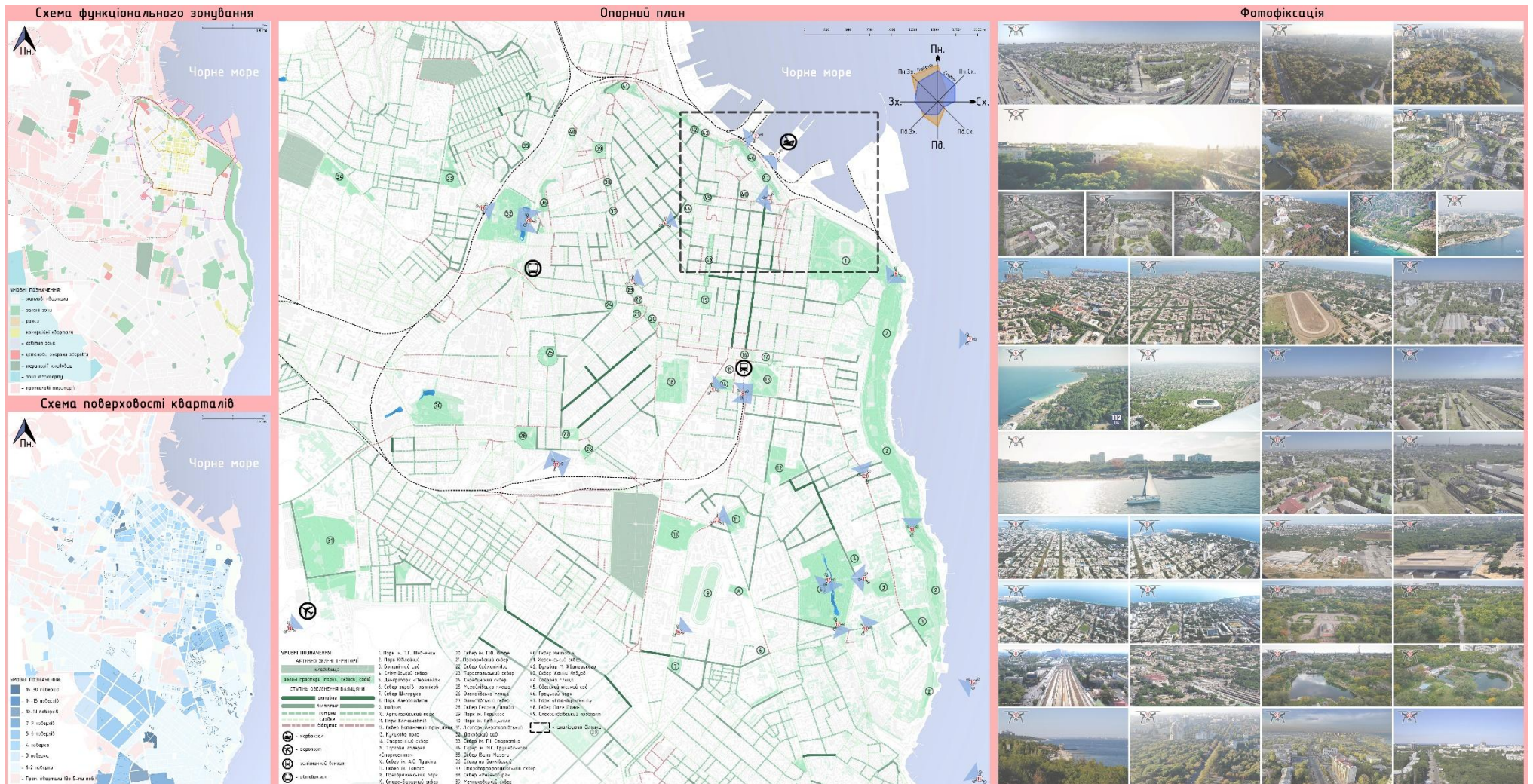
Схеми містобудівного аналізу. Головні: (схема функціонального зонування, опорний план з прив'язкою фотофіксації території); Додаткові: (схема поверховості)
