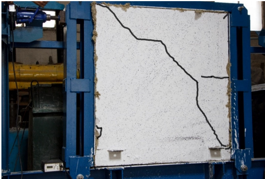
Рис. 4. Руйнування стінової панелі
