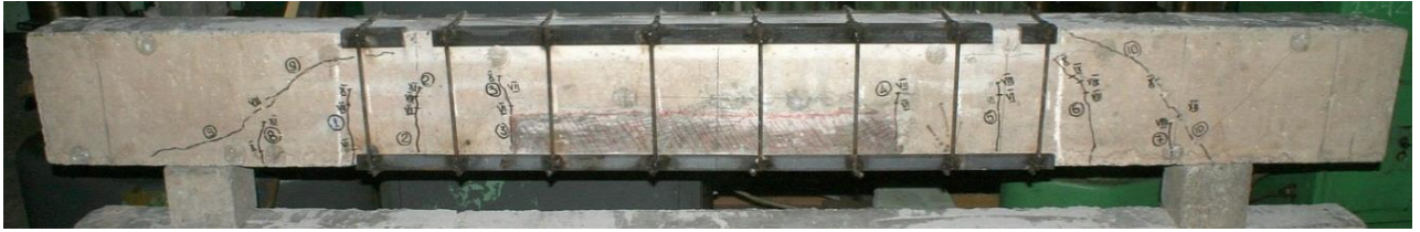
Рис. 3.44. Тріщини у зразку ЗБП6
