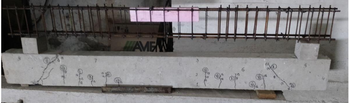
Рис. 3.17. Арматурний каркас, вкладиш та зразок після випробувань
