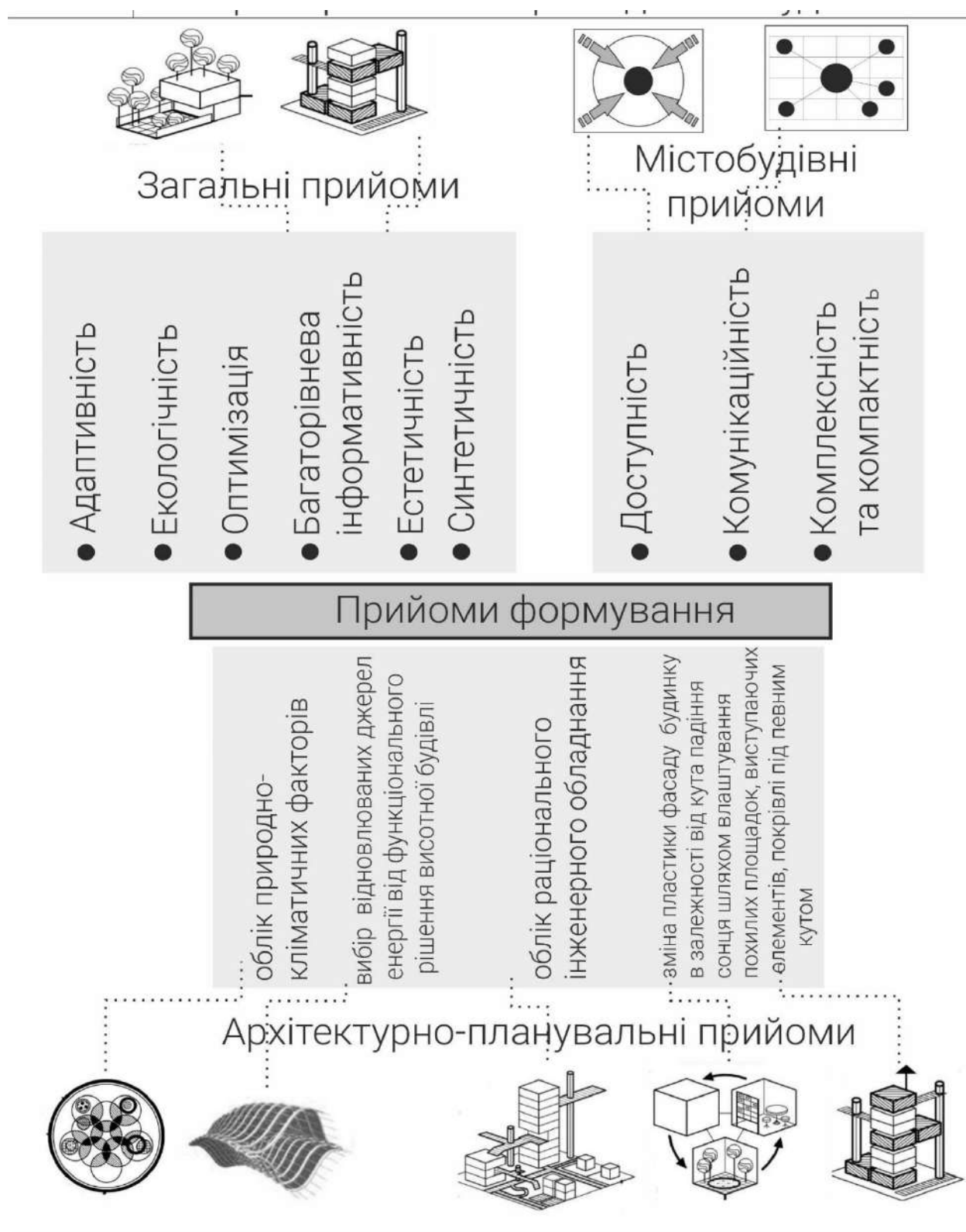
Рис. 3.4. Прийоми формування архітектури енергоефективних громадських будівель
