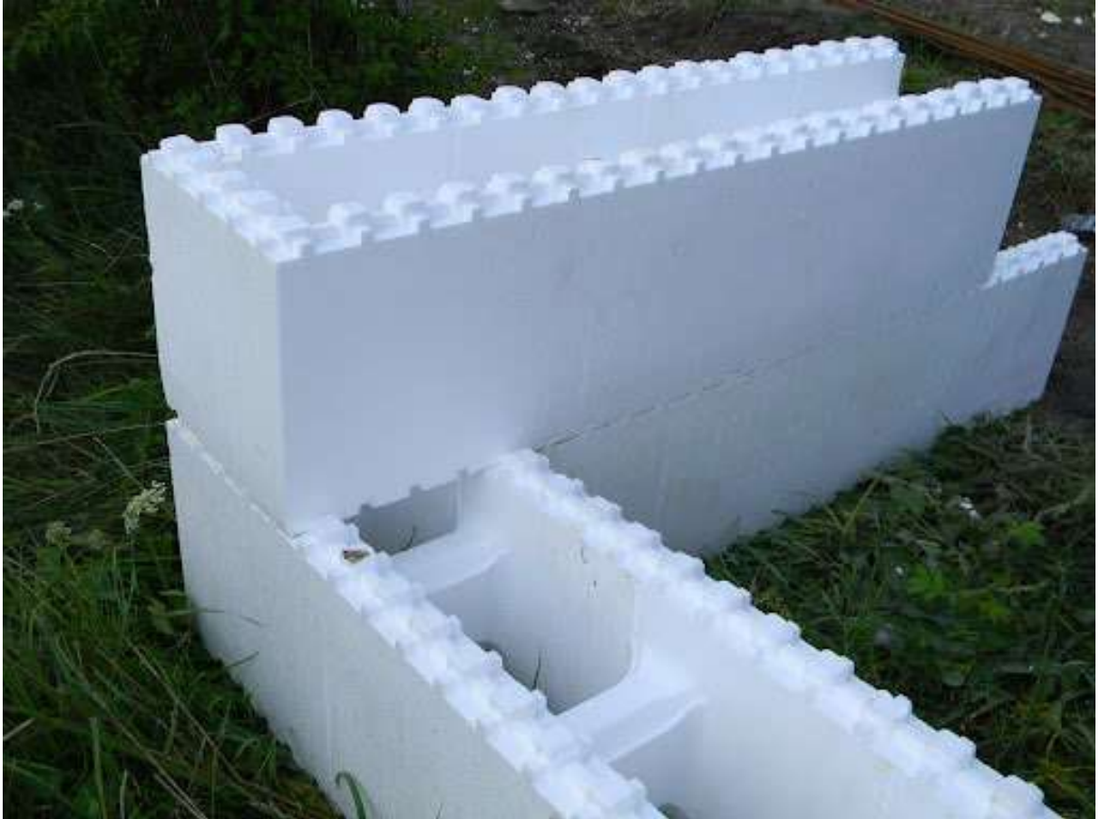
Рис. 1.1 – Загальний вигляд незнімної опалубки з пінополістирольних блоків
