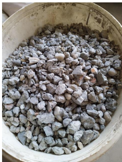
Рис. 2.9 Вторинний заповнювач фракції 8-16 мм з неоднорідним складом
