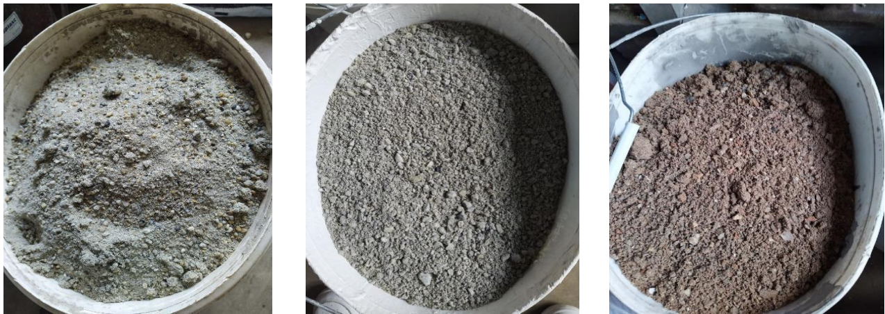
Рис. 2.7 Різновиди дрібного заповнювачу (піску), використаного при виготовленні досліджених бетонів: а – кварцовий пісок, б – вторинний пісок з перероблених залізобетонних конструкцій, в – вторинний пісок з переробленої цегляної кладки та керамічної плитки
