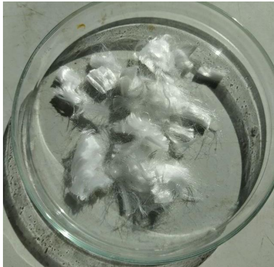
Рис. 2.8 Поліпропіленова фібра EGIBI PP 34 \mu\text{m}/12\text{ mm}
