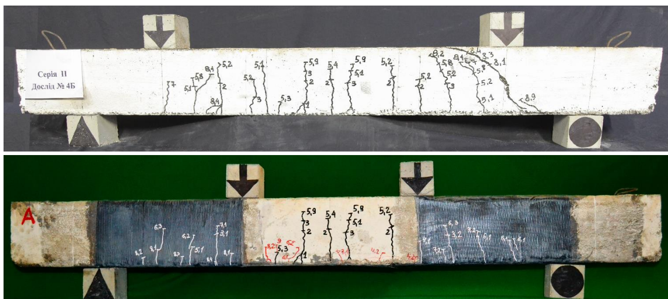
Рис.В2. Характер тріщиноутворення та руйнування бетонних балок № 3, 4 з BFRP до і після їх підсилення вуглепластиковим полотном у нижній розтягнутій зоні та на припорних ділянках
