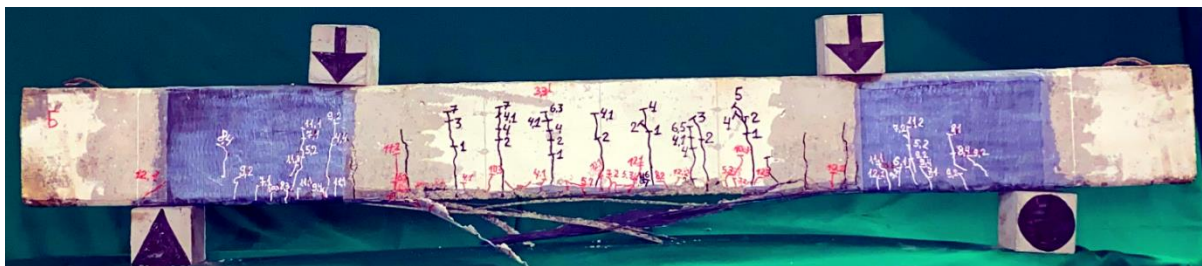
Рис. 2.1 - Характер тріщиноутворення та руйнування бетонних балок з BFRP до і після їх підсилення вуглепластиковим полотном у нижній розтягнутій зоні та на припорних ділянках з малим, середнім та великим прольотом зрізу
