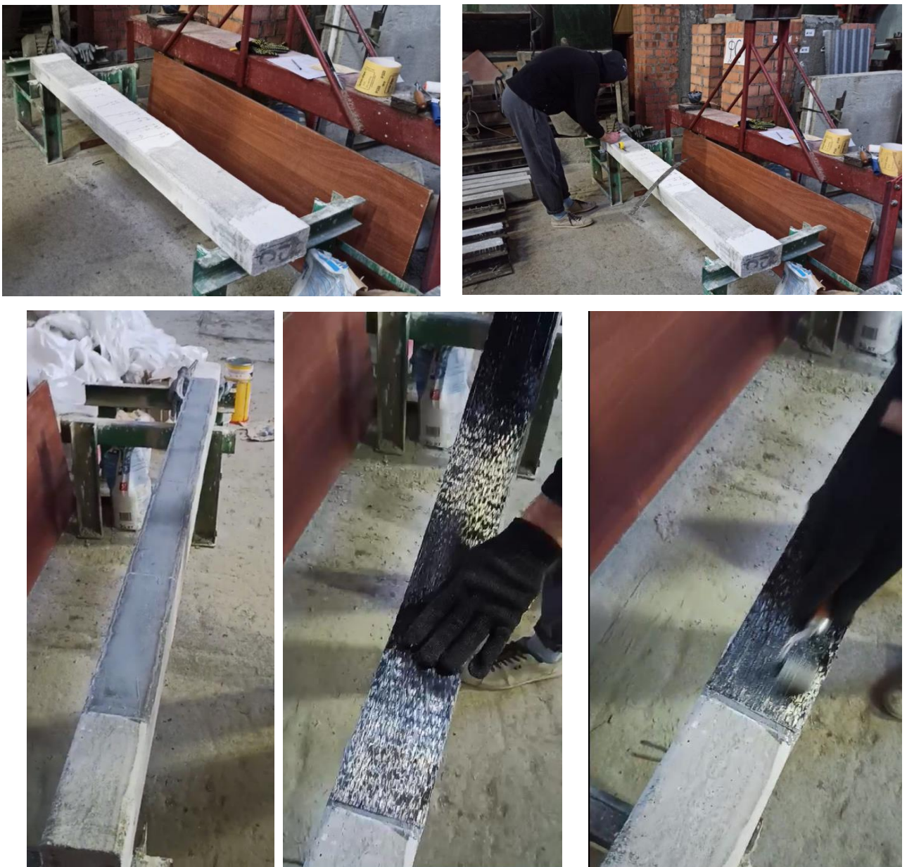
Рис. 2.2 Процес приклеювання вуглепластикового полотна Sika®Wrap®-230C двокомпонентною смолою Sikadur-300
