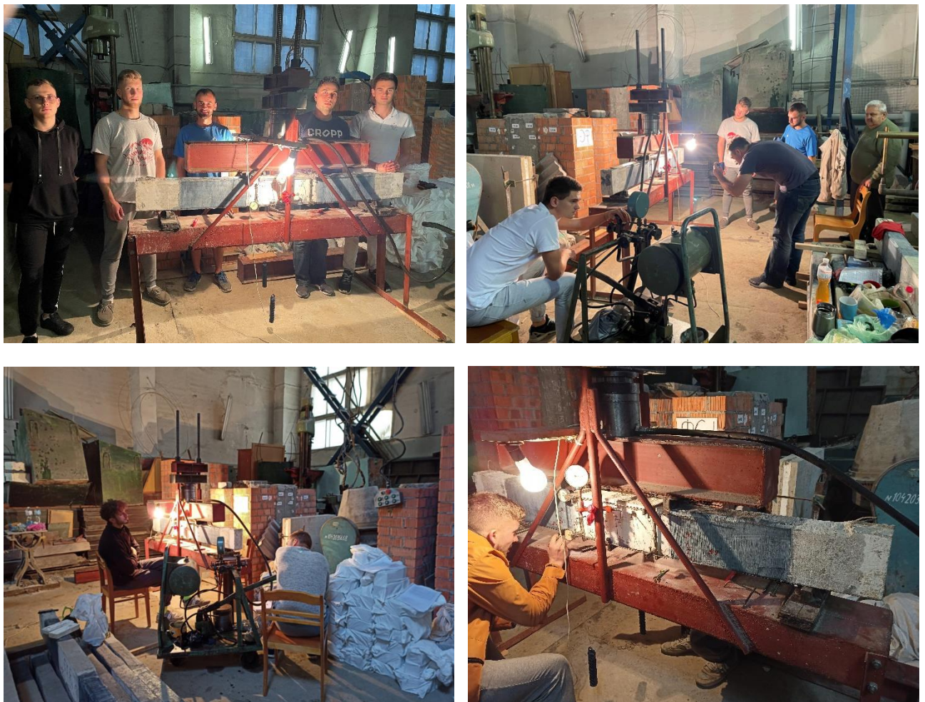
Рис. 2.3 Етап проведення експериментального дослідження дослідних зразків-балок
