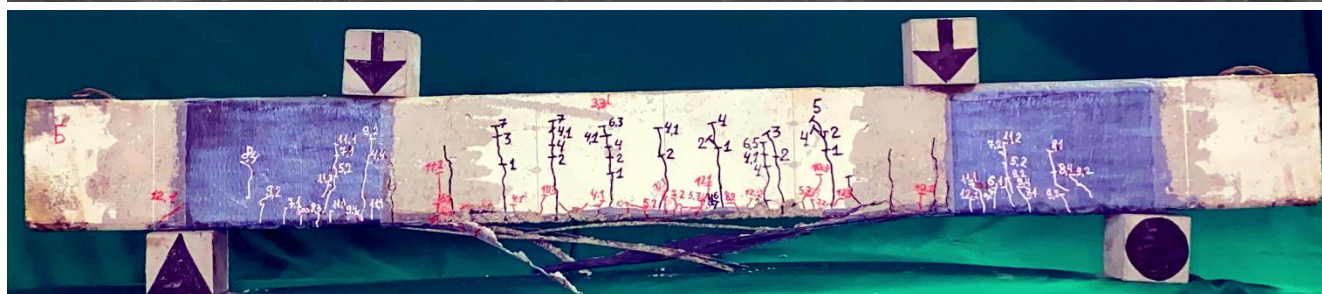
Рис.В6. Характер тріщиноутворення та руйнування бетонних балок № 11, 12 з BFRP до і після їх підсилення вуглепластиковим полотном у нижній розтягнутій зоні та на приопорних ділянках
