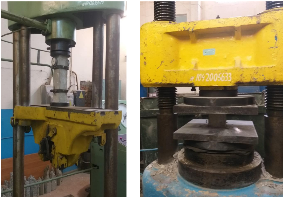
Рис. 2.13 – Фото випробування бетонних призм і кубів
