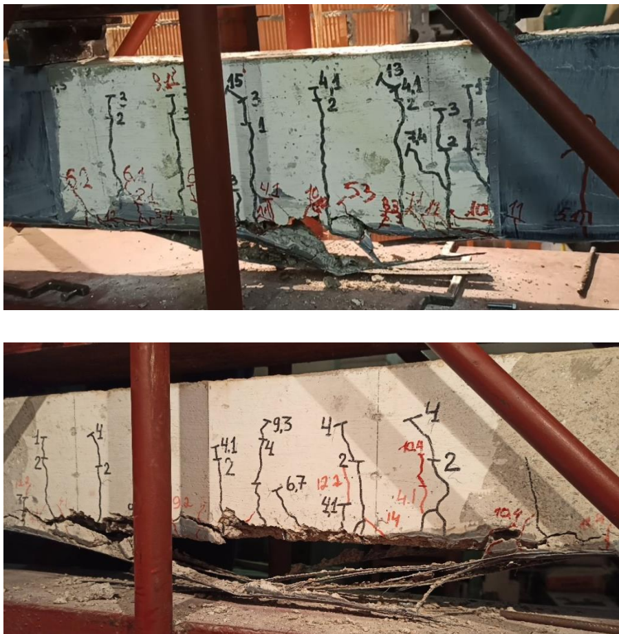
Рис. 2.4 Фрагменти руйнування дослідних підсилених базальтобетонних балок з великими і середніми прольотами зрізу
