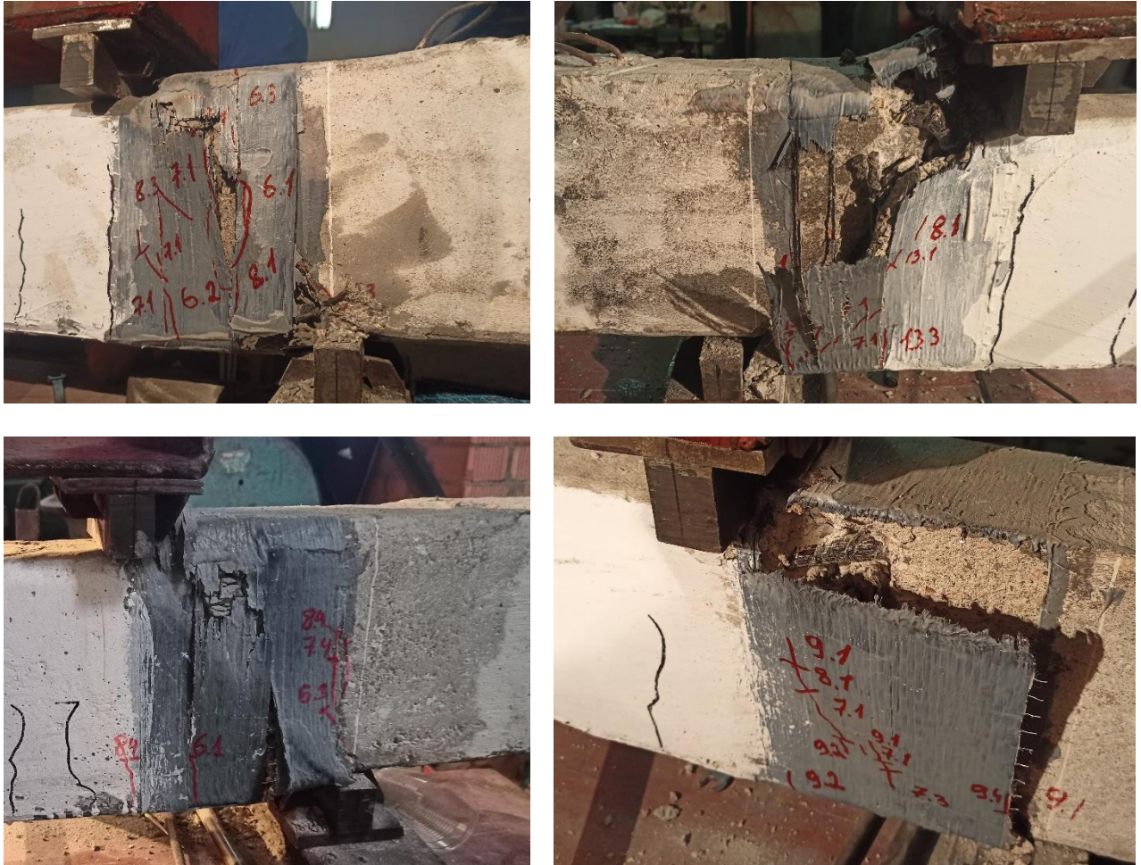
Рис. 2.5 Фрагменти руйнування дослідних підсилених базальтобетонних балок з малим прольотом зрізу
