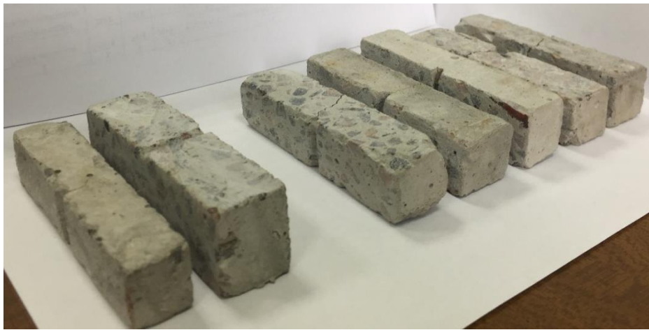
Рис. 3.6. Зразки для випробувань на ударну в'язкість
