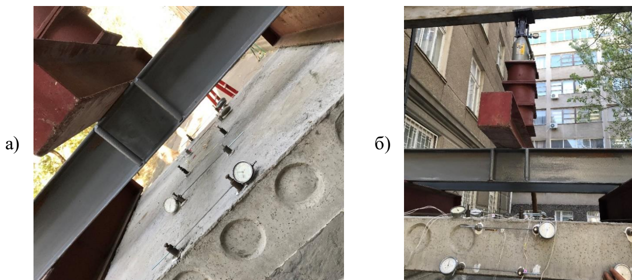
Рис. 4.6. Підготовка плити до випробувань:
