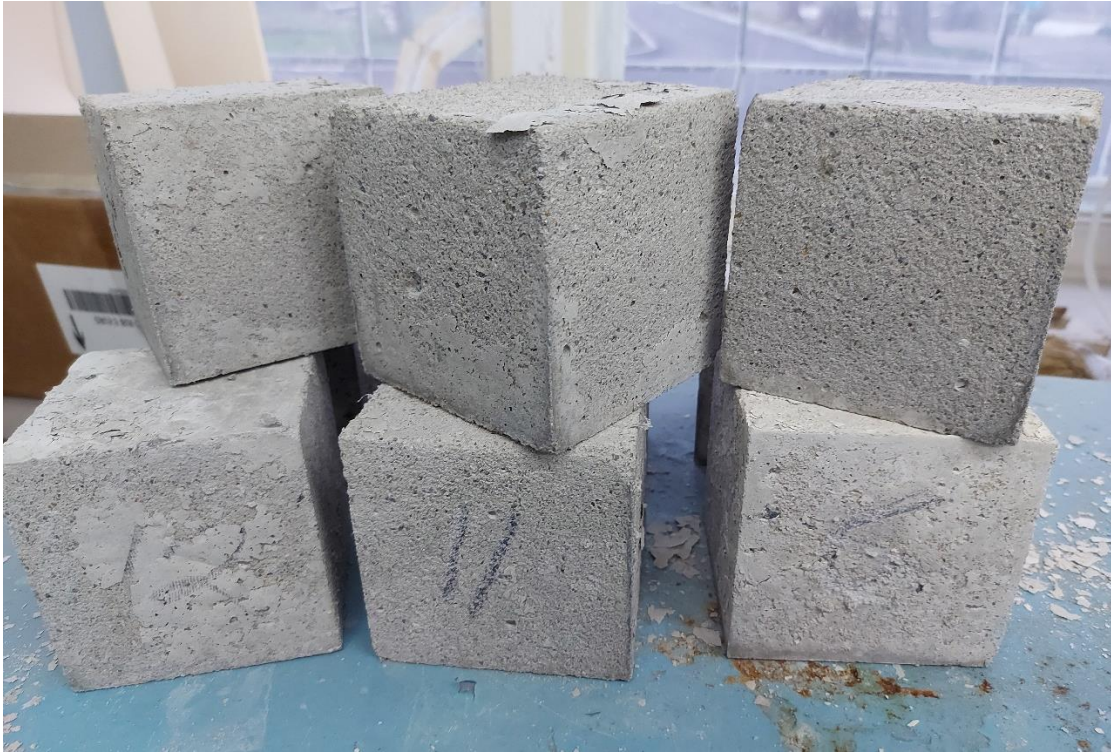
Рис.4.11 Фото зразків бетону складу №6 після 20 циклів заморожування при температурі -50\pm 5^{\circ}\text{C} і відтавання у 5% розчині хлористого натрію
