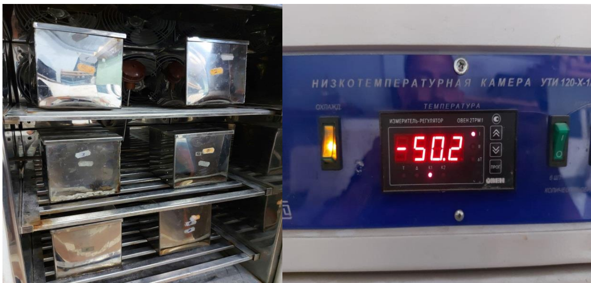
Рис. 2.2 Проведення випробування ремонтних бетонів на морозостійкість (3й прискорений метод)
