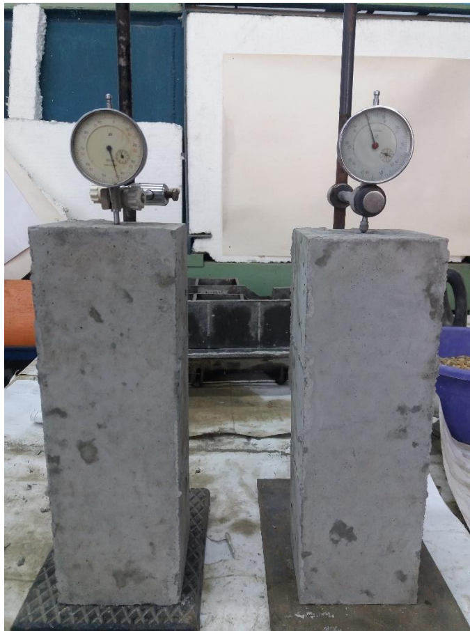
Рис. 2.3 Визначення усадки ремонтних бетонів
