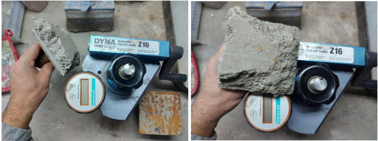
Рис.4.15 Визначення адгезійної міцності за методикою EN 1542:1999
