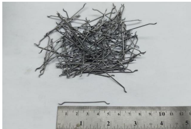
Рис. 2.1 Сталева анкерна фібра виробництва Стальканат Сілур м. Одеса
