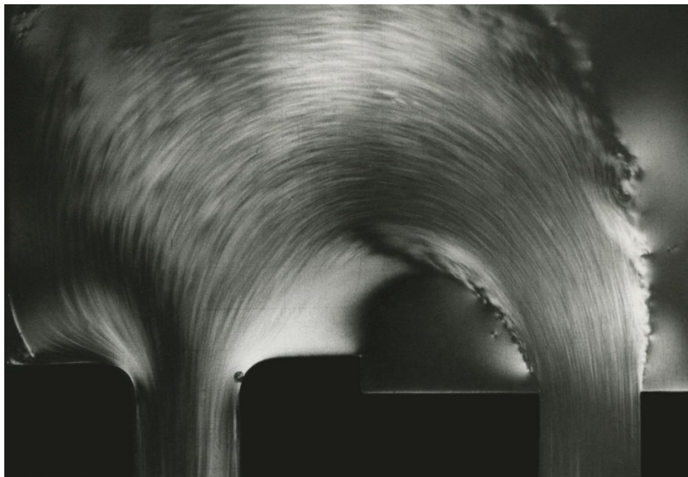
Рис. 3.4. Приклад візуальних даних про стан ГП в фізичному прототипі допоміжного елемента «поворот потоку на 180°»
