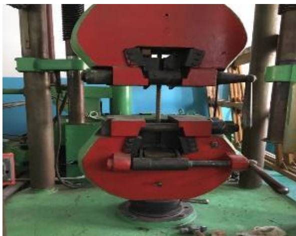
Рис. 3.23. Випробування арматури на розтяг
