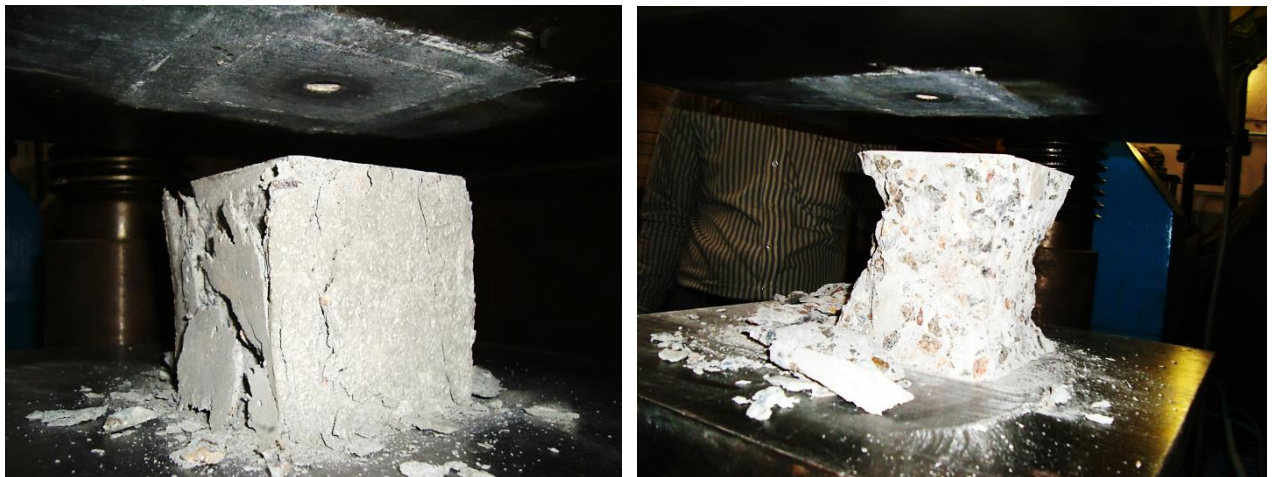
Рис. 3.20. Визначення кубкової міцності бетону в гідравлічному пресі
