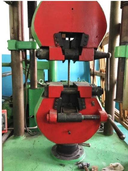
Рис. 2.14. Дослідження характеристик арматури в розривній машині ГРМ-2
