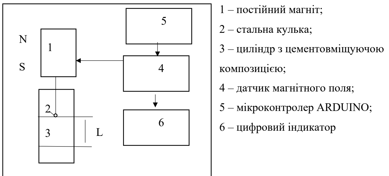
Рис.2.2. Принципова схема віскозиметру
