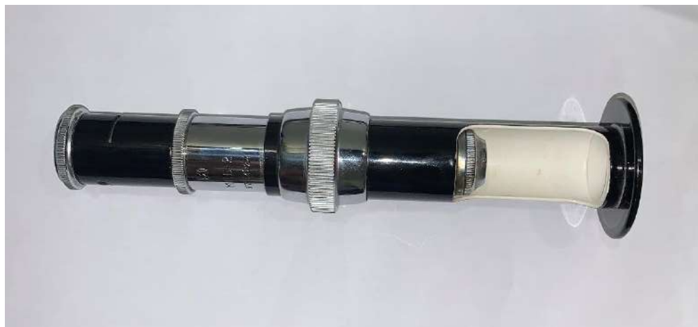
Рис.2.15. Мікроскоп МПБ-2 для вимірювання ширини розкриття тріщин в дослідних зразках
