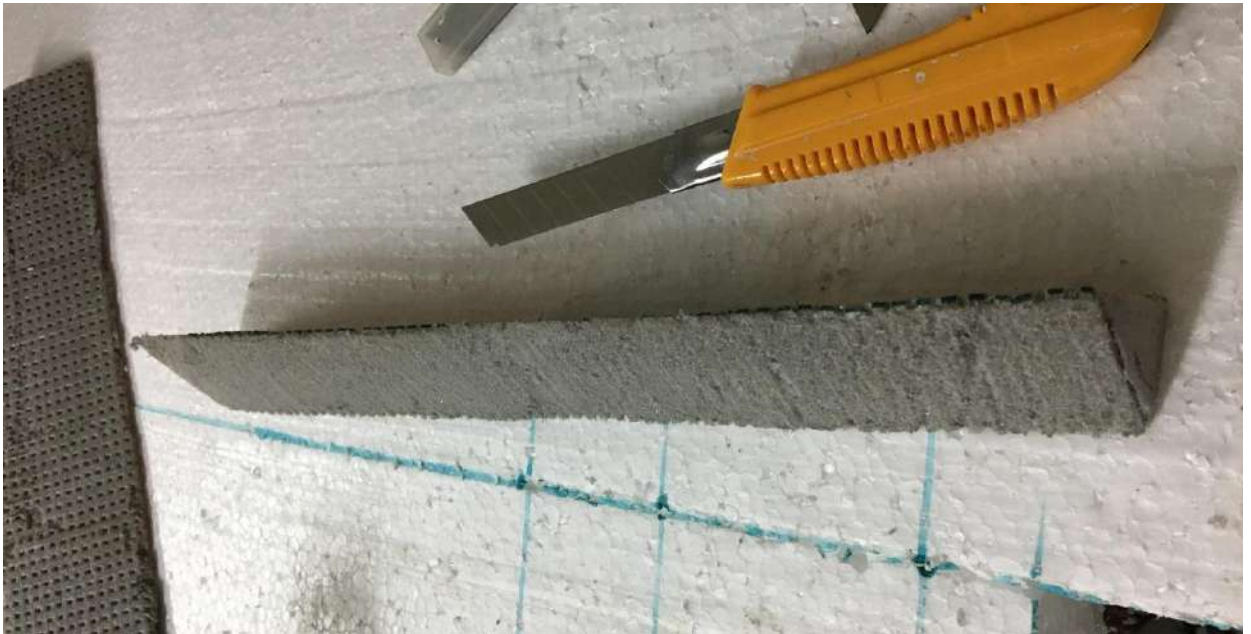
Рис.2.5. Заготовка із пінополістиролу для імітації пошкодження балки
