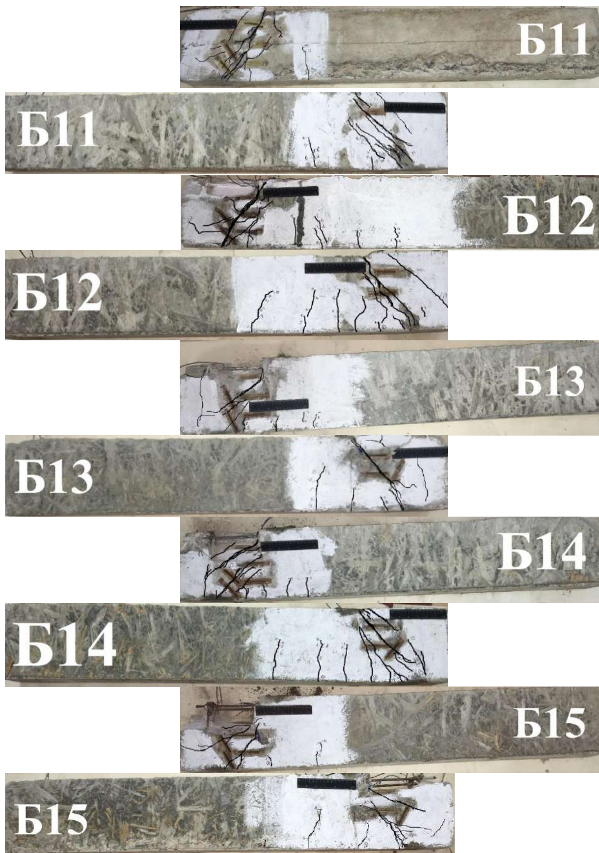
Рис.3.13. Характер утворення, розкриття тріщин та руйнування дослідних балок з прогоном зрізу 170 мм
