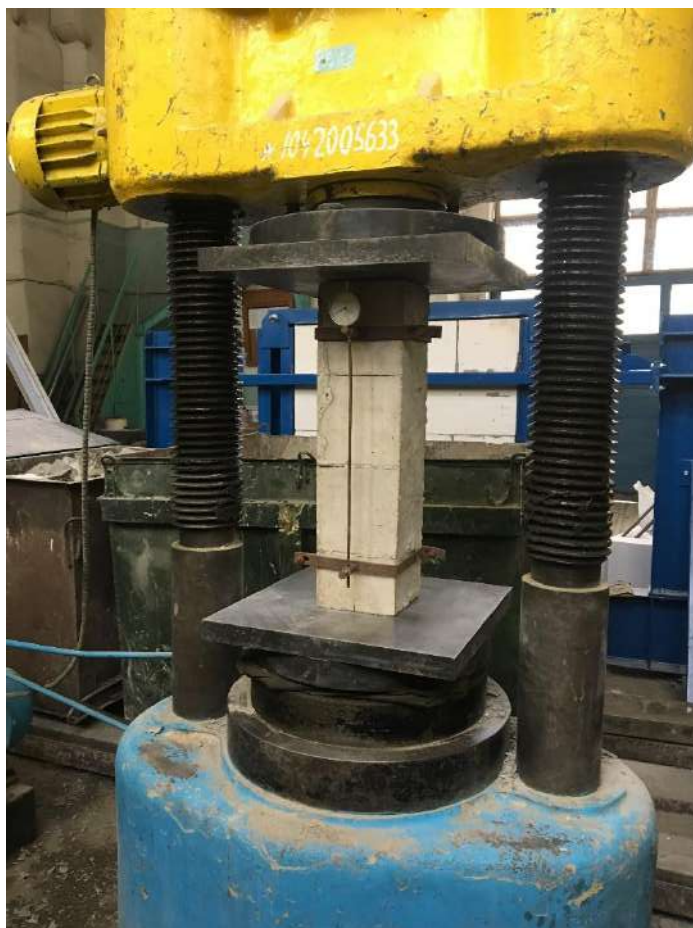
Рис.2.8. Випробування контрольних зразків на пресі ЗІМ ПСУ-250
