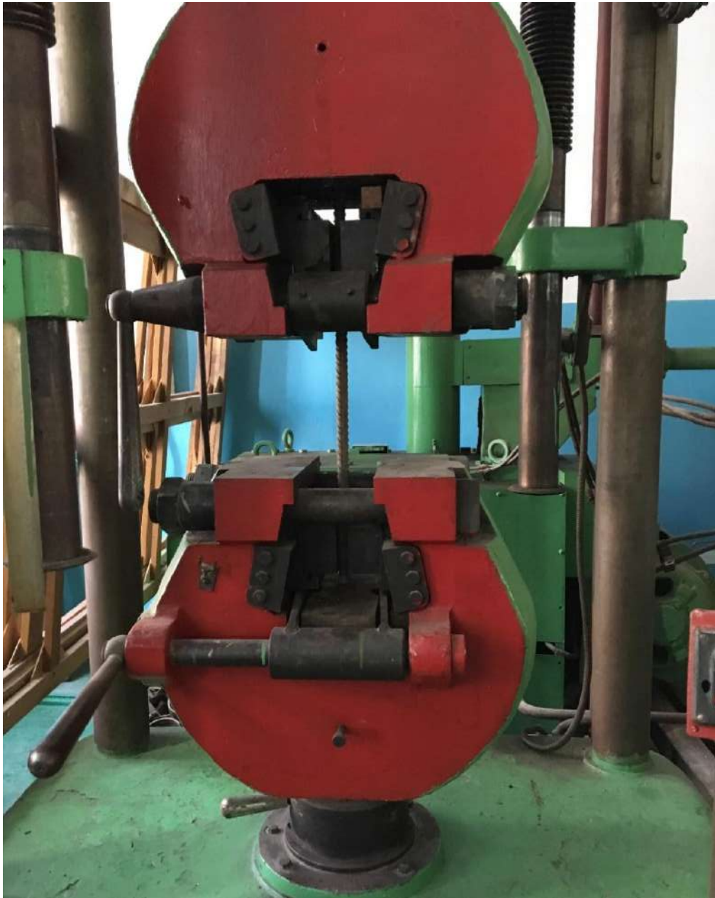
Рис.2.9. Випробування арматури на розтяг на розривній машині ГРМ-2
