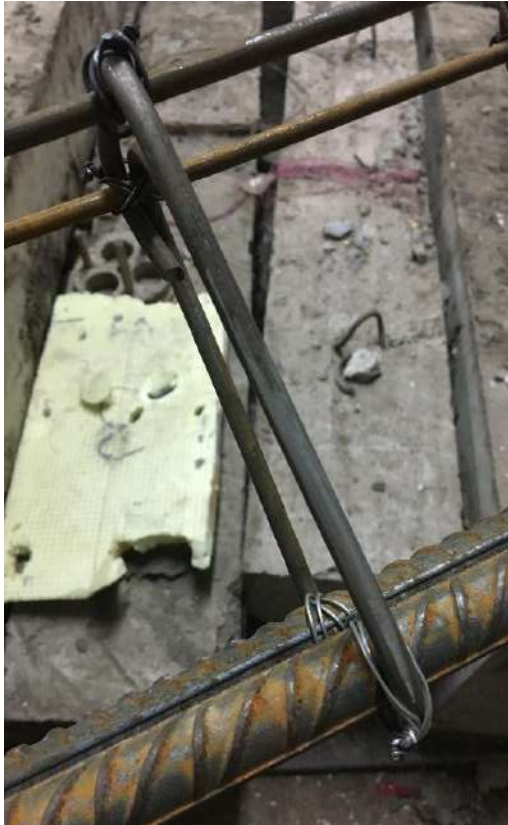
Рис.2.4. Процес приклеювання тензорезисторів на поперечну арматуру:
