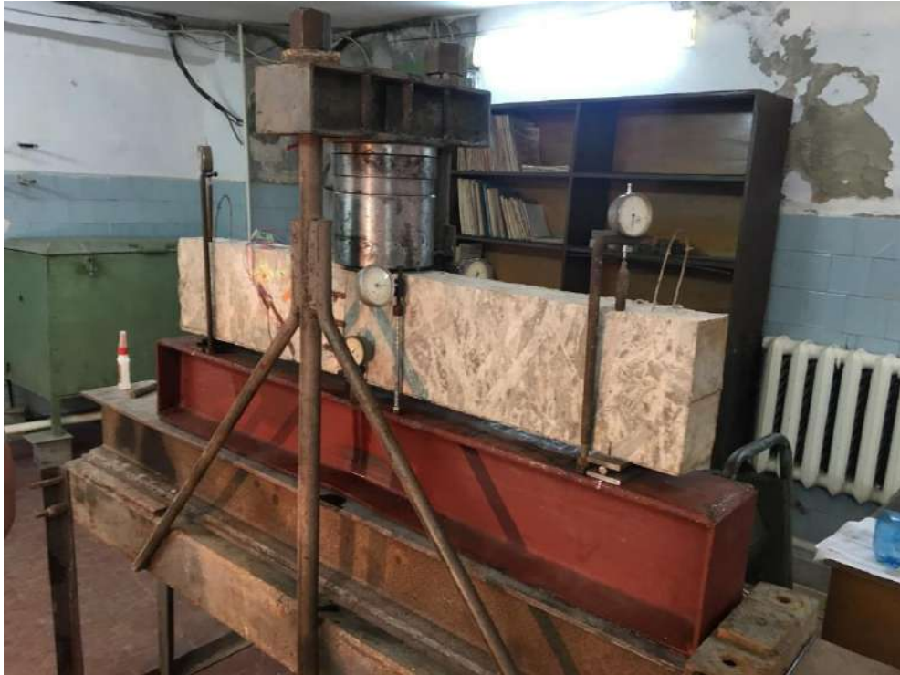
Рис.2.16. Загальний вид дослідної залізобетонної балки під час проведення дослідження
