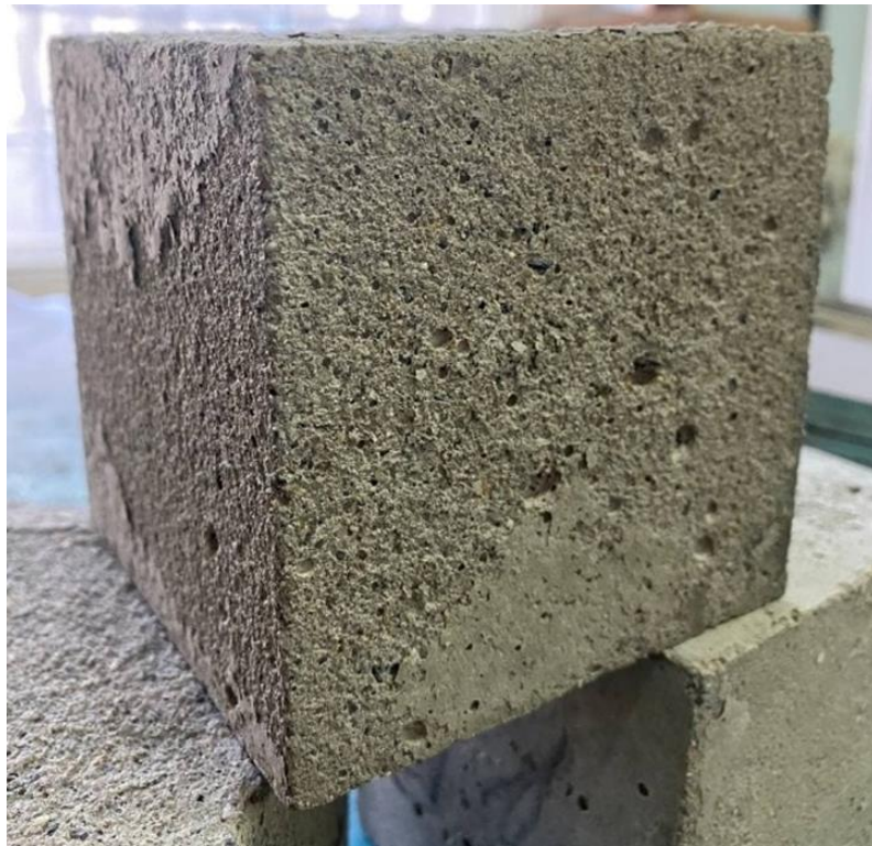
Рис.3.7 Вигляд зразку бетону після проведення 20 циклів заморожування у відтавання у солоній воді згідно ДСТУ Б В.2.7-49-96
