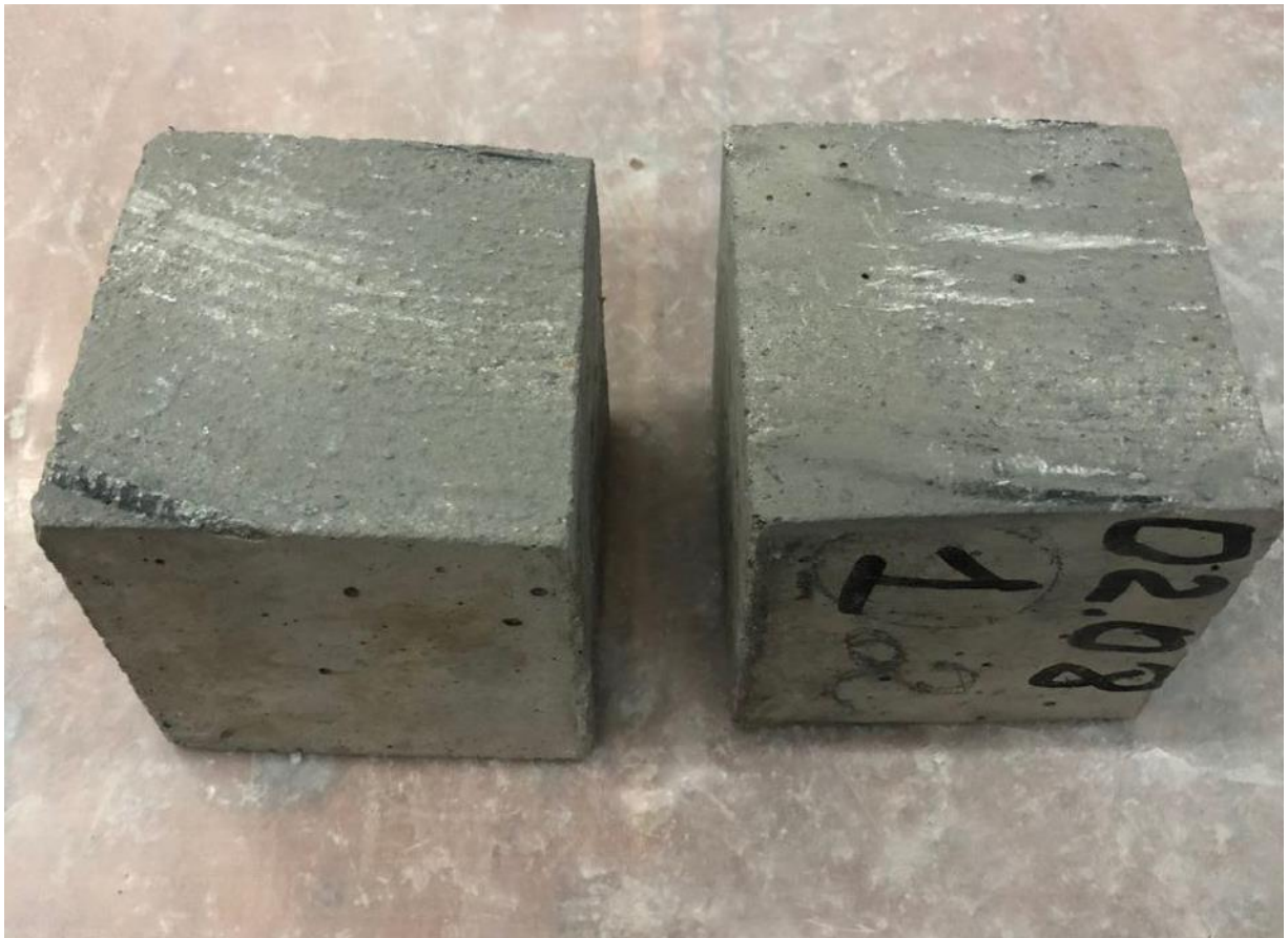
Рис.4.10 Фото зразків фібробетону (склад №1) після проведення визначення стираності на колі стирання ЛКИ-3
