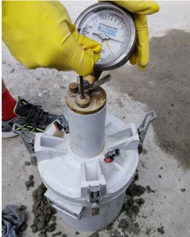
Рис.2.1 Визначення кількості залученого до бетонної суміші повітря з використанням пороміру UTC-0650
