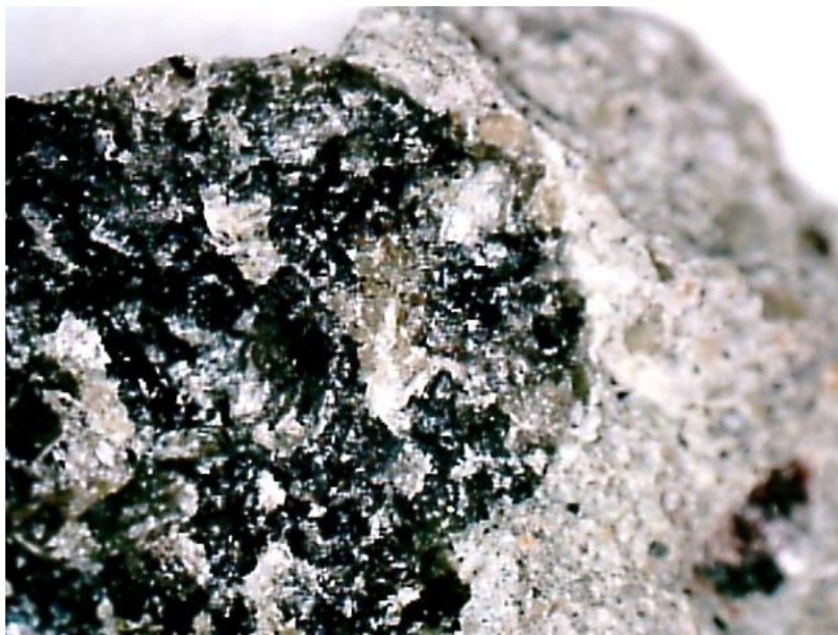
Рис.4.15 Макроструктура фібробетону складу №15
