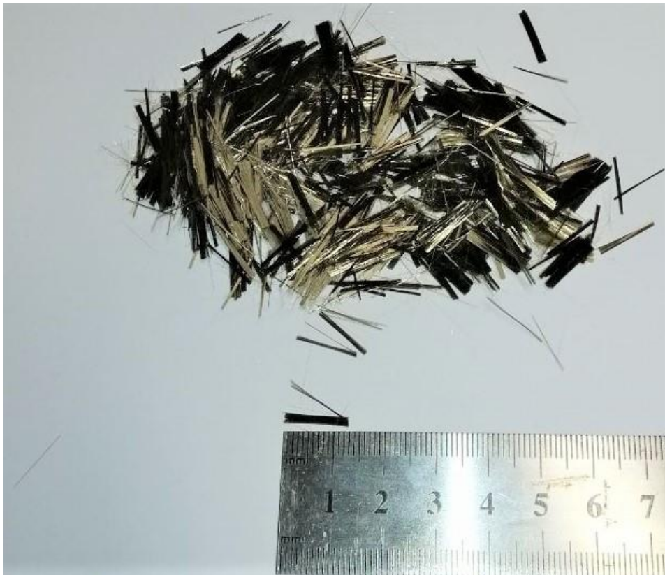
Рис.2.3 Вигляд волокон базальтової фібри BAUCON®-bazalt
