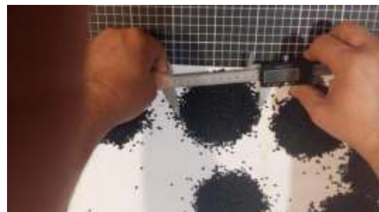
Рис. 2.16. Визначення кута внутрішнього тертя сухих гранул гумової крихти
