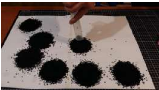
Рис. 2.16. Визначення кута внутрішнього тертя сухих гранул гумової крихти
