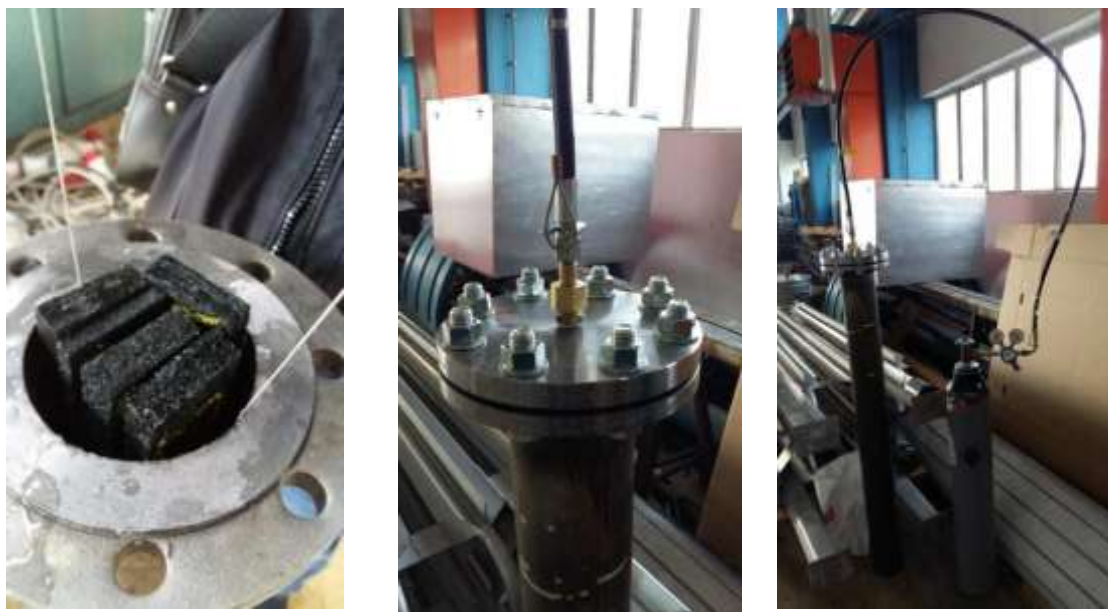
Рис. 2.13. Конструкція посудини під тиском та пристрій для проведення випробувань
