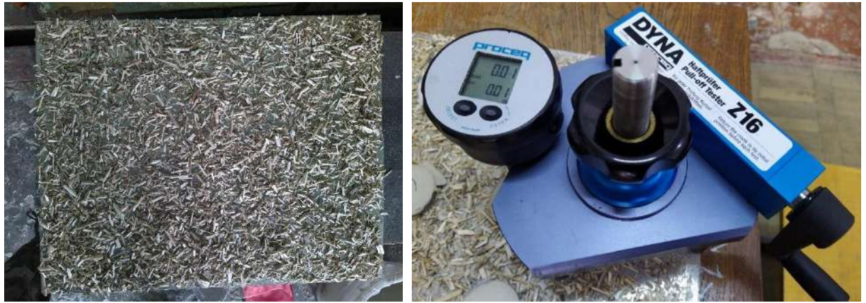
Рис.2.4. а) Металева пластина з приклеєною костою коноплі; б) Визначення адгезійної міцності арболитобетона за допомогою адгезіометра Proceq Dyna Z16
