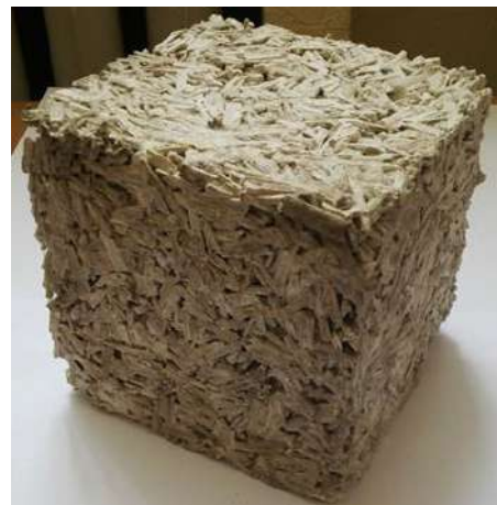
Рис. 3.1. Зразки арболітобетону на: а) вапняному; б) композиційному гіпсовому в'язучому.
