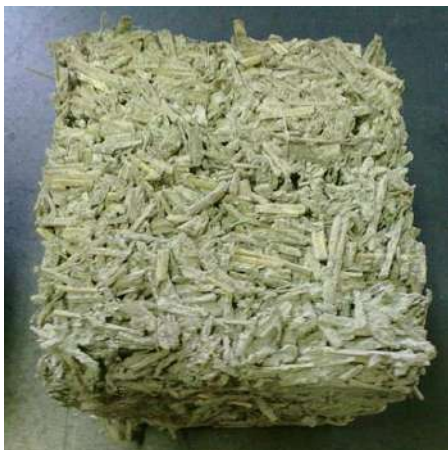
Рис. 3.1. Зразки арболітобетону на: а) вапняному; б) композиційному гіпсовому в'язучому.
