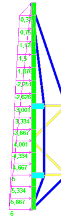
Рис. 3.1 Гідростатичне навантаження при повному заповненні ( \text{т/м}^2 )
