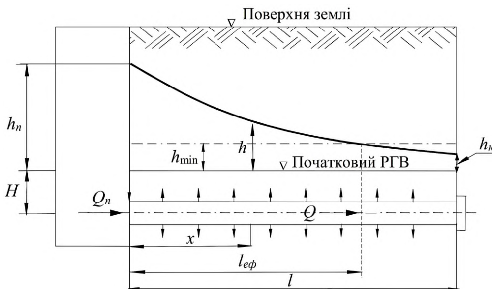
Рис. 1. Схема роботи розподільчого дренажного трубопроводу з ефективними конструктивними характеристиками
