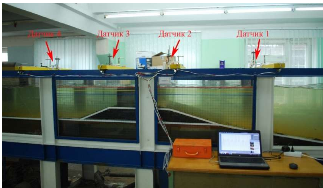
Рис. 5.9. Модель огорожувальної гідротехнічної споруди неповного вертикального профілю в хвильовому лотку при розрахунковому випадку рівня води А (червона лінія)
