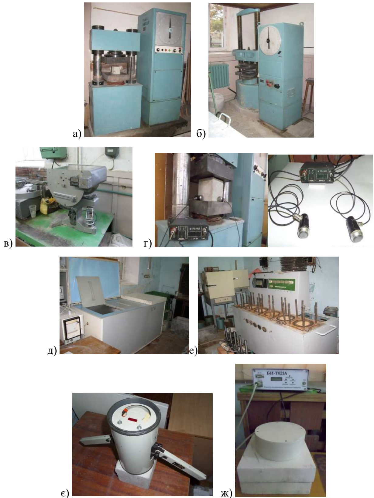
Рис. 5.19.Випробувальне обладнання лабораторії: а – прес 100т; б – прес 125т; в – прилад МІІІ100; г – прилад УК14П; д – морозильна камера; е – установка для визначення водонепроникності бетонів за методом «Мокра пляма»; е – прилад АГАМА-2р; ж – прилад для прискореного визначення теплопровідності БИ-Т021
