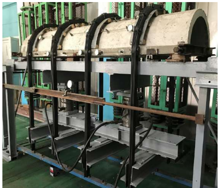
Рис.5.7.Експериментальне дослідження зразків балок, перехресних систем, арок, оболонок з бетону та фібробетону
