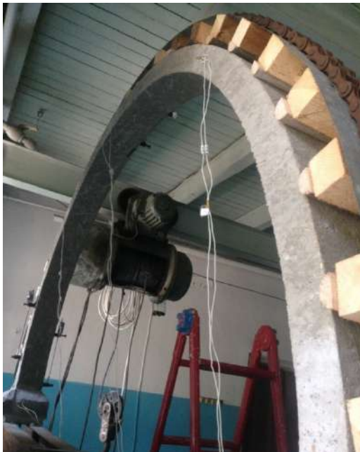
Рис.5.7.Експериментальне дослідження зразків балок, перехресних систем, арок, оболонок з бетону та фібробетону
