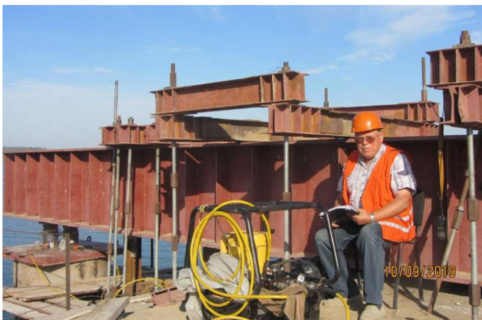
Рис. 5.16. Статичні випробування бурових паль на опорах правої смуги мосту через Хаджибейський лиман напрямку Київ-Одеса, на автомобільній дорозі державного значення Київ-Одеса(М-05). Керівник робіт – с.н.с. Кушак С.Й.
