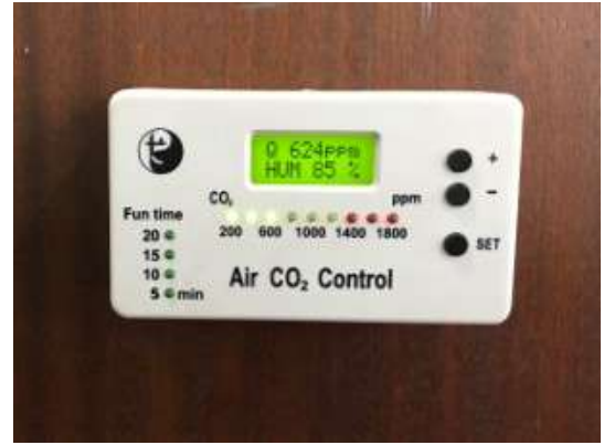
Рис. 5.12 Датчик концентрації CO 2 інтелектуальної системи управління
