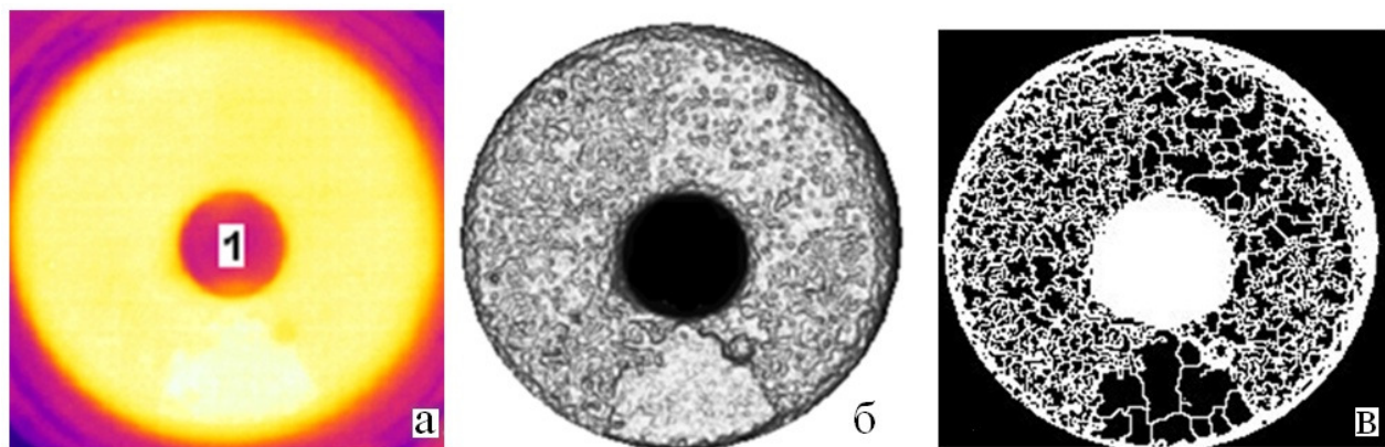
Рис.11. Етапи виділення термічних осередків у будівельному гіпсі Г10, що твердне протягом 2 хв: а – тепловізорне зображення; б – результат виділення границь; в – виявлення теплових комірок методом вододілу; 1 – модель структуроутворюючої частки
