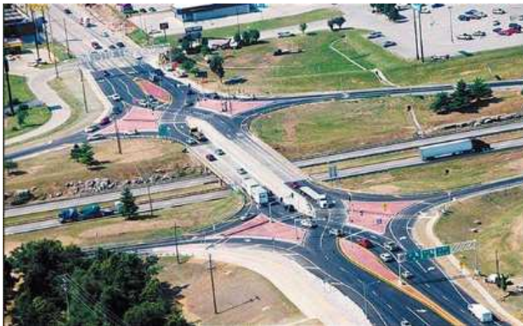
Рис.4. Одна из последних новинок в схемах транспортных развязок - «расходящийся бриллиант».
