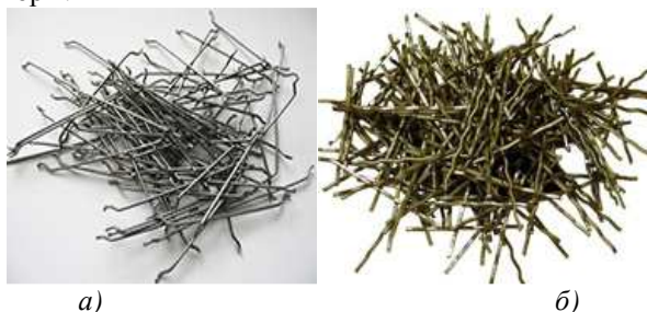
Рис.1. Основные виды стальной фибры: а) анкерная; б) волновая.
