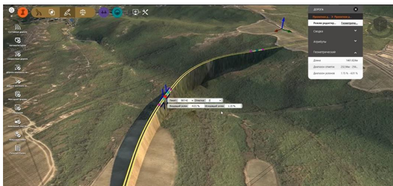
Рис. 1. Отримання та обробка геодезичної зйомки з вилученням лінійних елементів з хмари точок у InfraWorks
