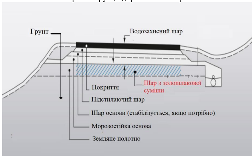
Рис. 2 Особливості та вимоги до використання золошлаків в дорожньому будівництві
