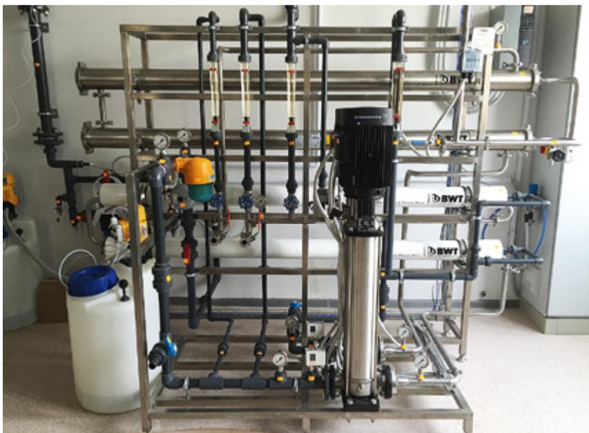
Рис. 1 Установа двоступеневого зворотного осмосу
