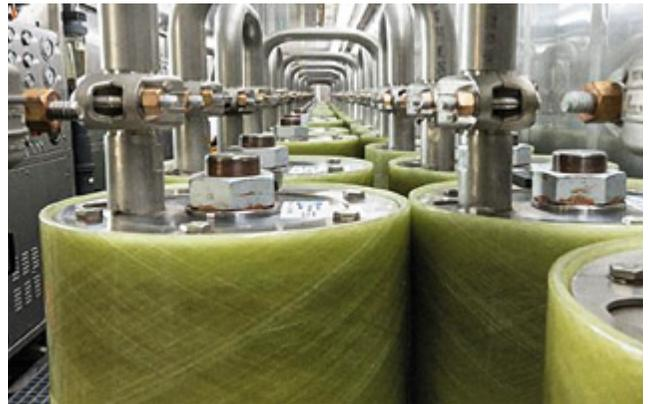
Рис. 3. Мембранный модуль Rochem Spacer Tube (ST)
