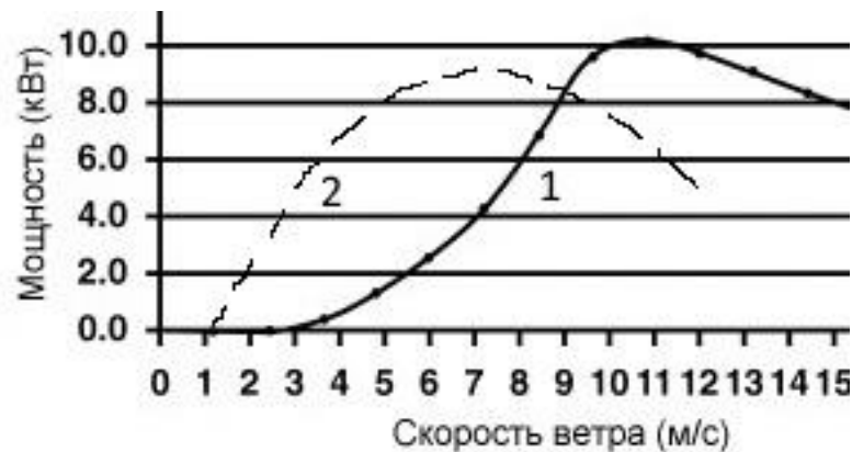
Рис. 4 Потужність вітряків при різній швидкості вітру 1 – горизонтальна вісь; 2 – вертикальна вісь
