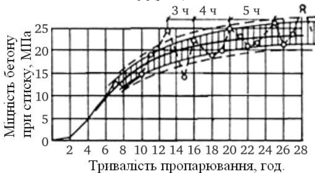
Рис.1. Процес зміни міцнісних характеристик бетону, що твердіє; його обгинальні та усереднені тимчасові характеристики
