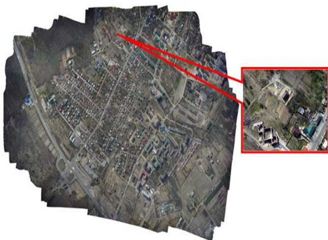
Рис.2 – Ортофотоплан м.Винники біля Львова, отриманий за даними аерознімання з БПЛА у 2015 році
