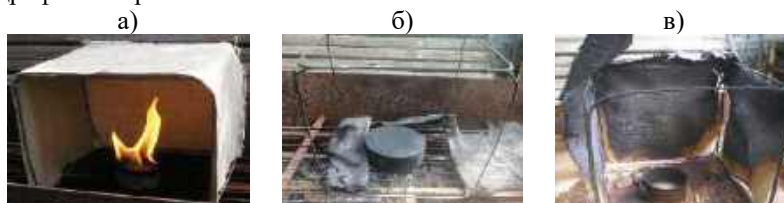
Рис. 1. Результати випробувань необробленого модельного зразка елементів намету, виготовленого з парусинової тканини:
