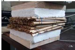
Рис. 2. Процес визначення теплопровідності зразка мату, виготовленого з очерету, під дією нагрівача
