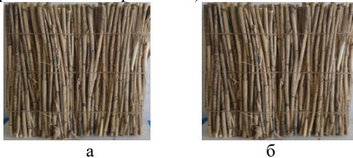
Рис. 1. Модельні зразки теплоізоляційних матів з очерету: а – необроблений; б – оброблений модифікованим покрівельним просочувальним розчином «Skela-i»
