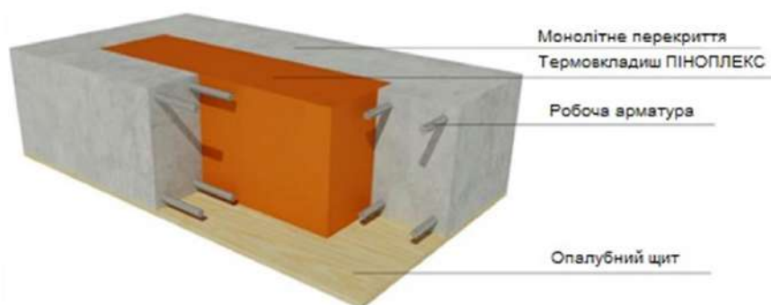
Рис. 1. Схема розташування термовкладиша ПІНОПЛЕКС на стадії монолітних робіт
