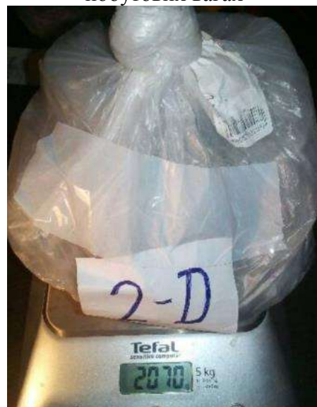
Рис. 8. Зважування зразка цементу 2-Д на побутових вагах
