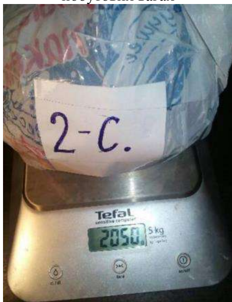
Рис. 7. Зважування зразка цементу 2-С на побутових вагах
