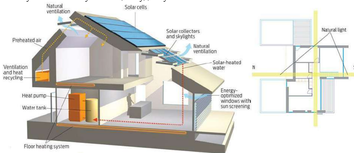
Рис. 4. Схема роботи House of Life
