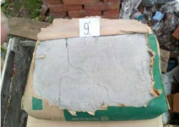
Рис. 3. Приклад розкритого мішка цементу з другої партії для відбору проб
