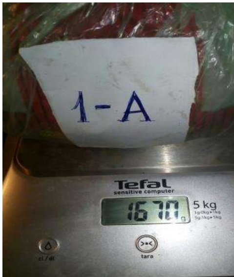
Рис. 5. Зважування зразка цементу 1-А на побутових вагах
