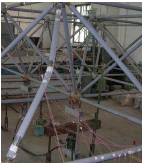
Рис. 1. Втрата стійкості стержня з перерізом з круглої труби
