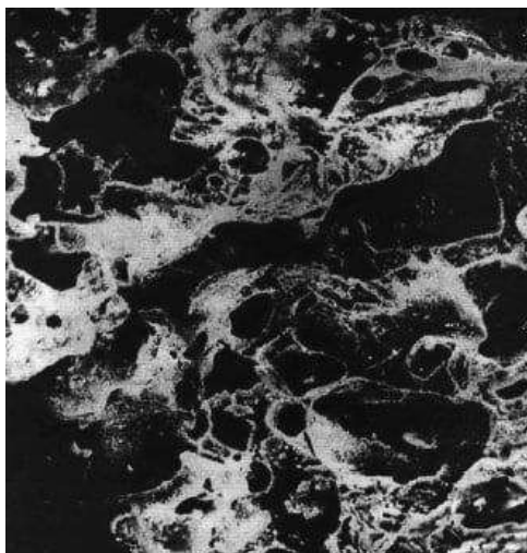
Рис. 1. Знімки ядра керамзиту під мікроскопом у збільшенні в 500 разів
