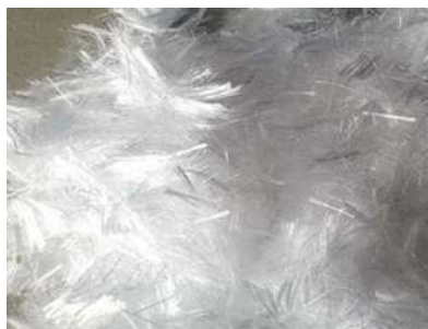
Рис. 3. а) Скловолоконна фібра; б) Поліпропіленова фібра.
