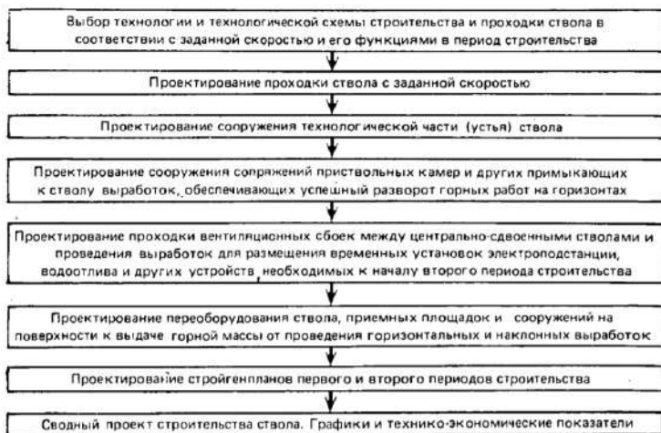
Рис. 3. Порядок проектирования строительства стволов шахт.
