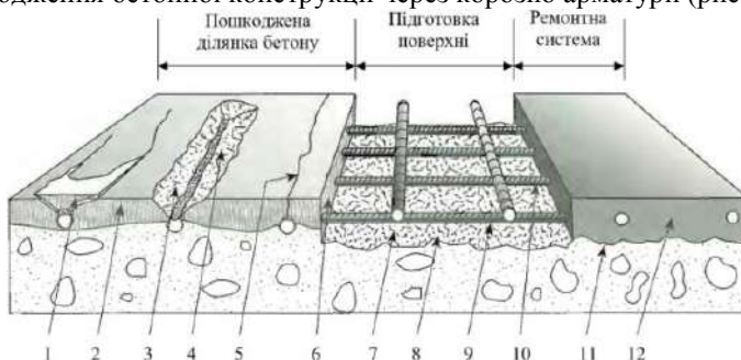
Рис. 4. Узагальнена модель пошкодження бетону при корозії [9]:
