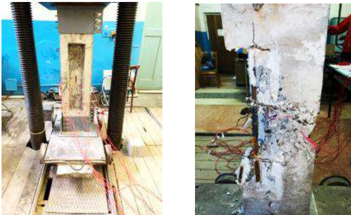
Рис. 4. Дослідні колони під час та після випробувань.
