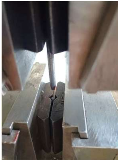
Рис. 2 – Деформування сталевих цвяхів
