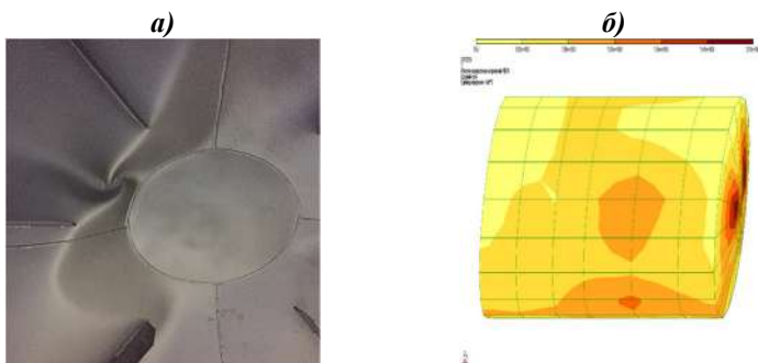
Рис. 4 – Порівняльний аналіз реальних деформацій циліндричного резервуару (а) із чисельно-аналітичною моделлю (б)
