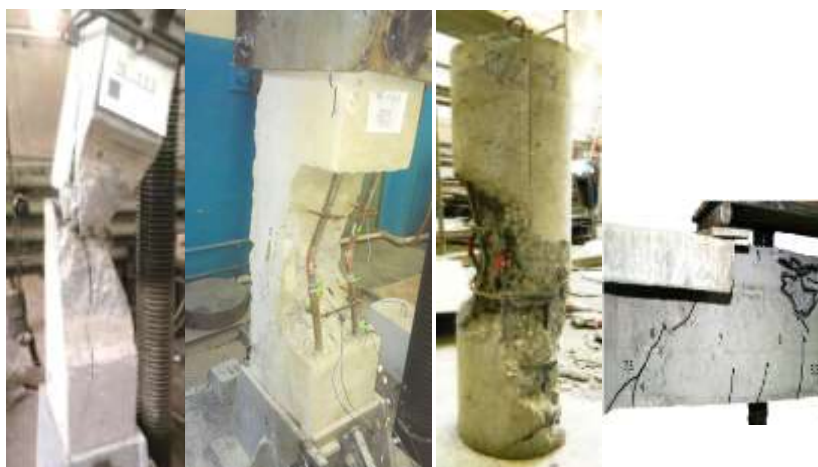
Рис. 2. Дослідні зразки після випробувань: а – бетонні стійки; б – прямокутні колони; в – стиснуті елементи круглого профілю; г – таврові балки
