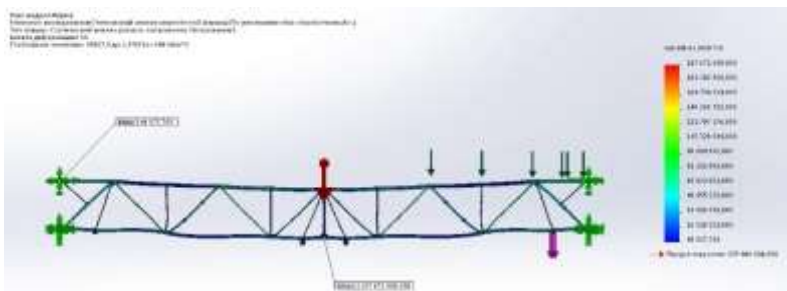
Рис. 5. Напруження в елементах оптимізованої ферми
