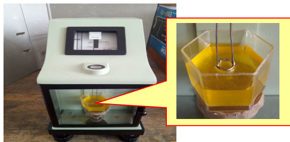
Рис. 2. Визначення поверхневого натягу покриття
