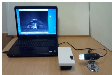
Рис. 1. Визначення крайового кута змочування покриття
