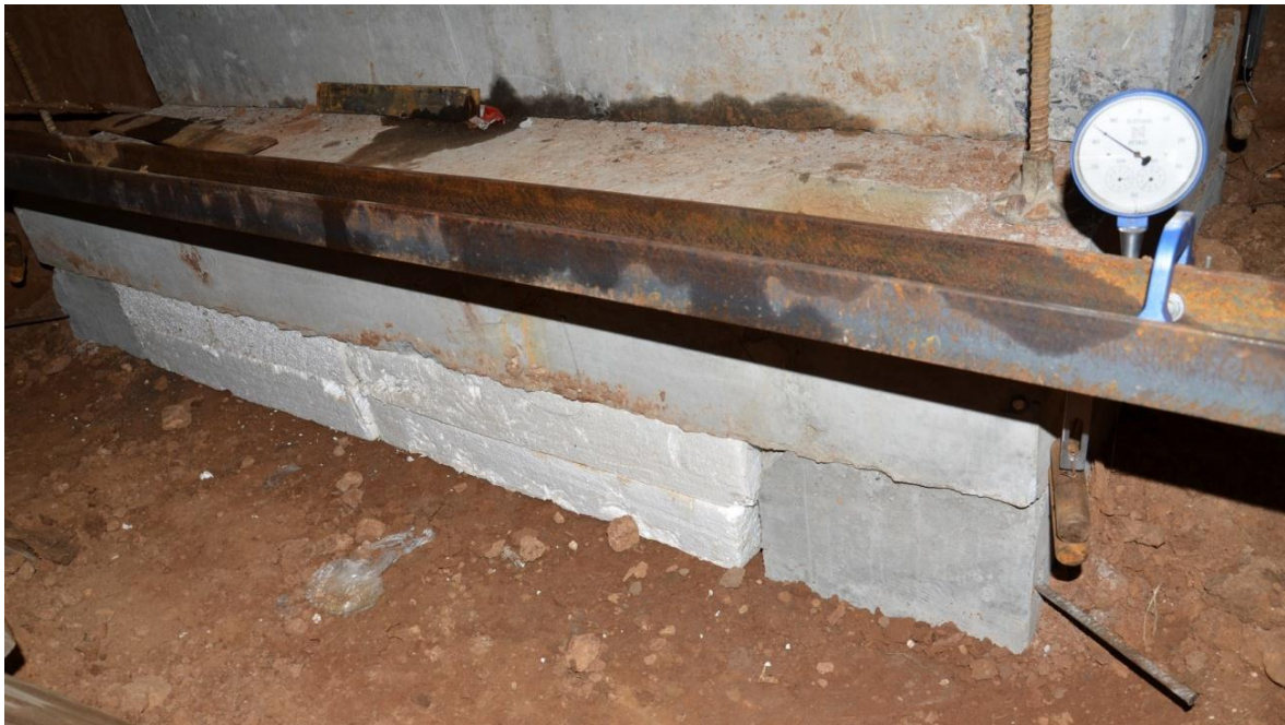
Рисунок 12 – Фундамент з вирізом по підшві ( a/B=0,7 )
