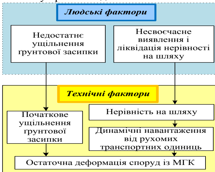
Рис. 8. Механізм розвитку залишкових деформацій транспортних споруд із МГК
