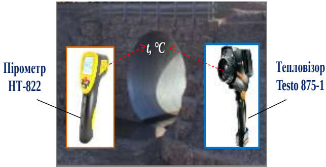
Рис. 16. Процес проведення вимірювань температури на поверхні металевих гофрованої конструкції споруди
