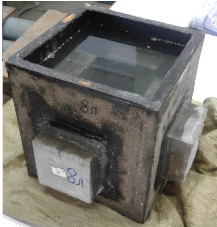
Рис.3.2. Установка для дослідження корозійної стійкості бетонів при однобічному впливі агресивної рідини
