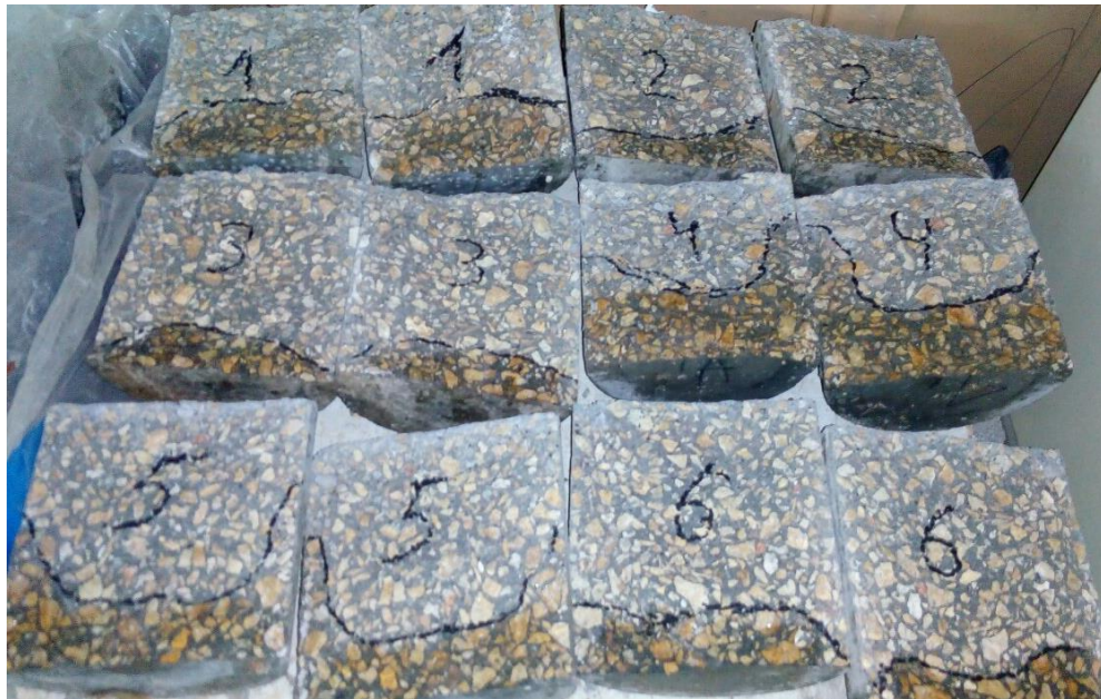
Рис.6.8. Зовнішній вигляд зразків-циліндрів бетону на вапняковому щебені, які були розколоті після випробування на водонепроникність
