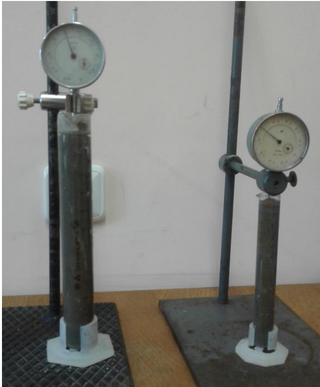
Рис.3.11. Визначення об'ємних змін пористого заповнювача при набуханні та усадці в модельній системі цементно-піщаного розчину
