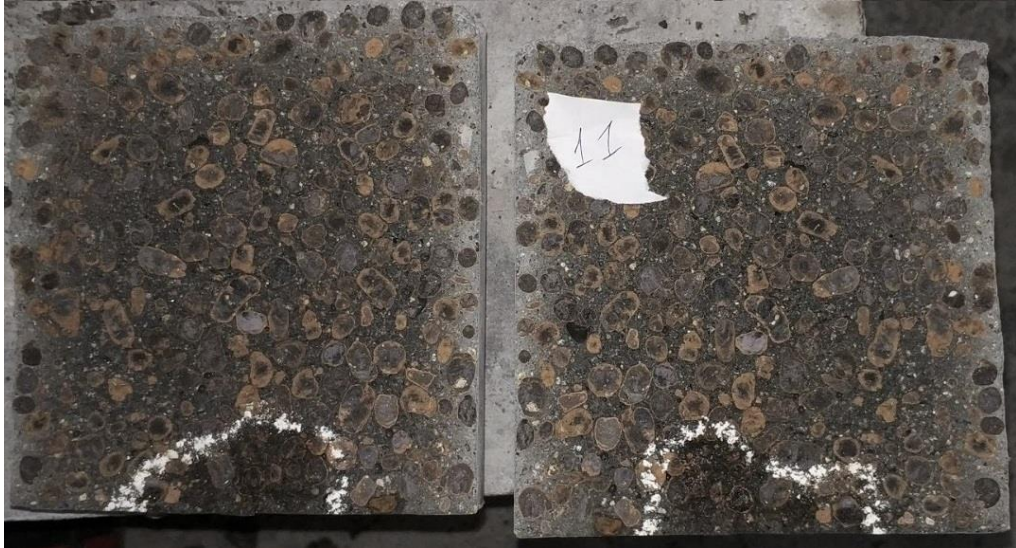
Рис.4.9. Приклад структури дослідженого керамзитобетону (циліндр, який був розколотий навпіл після випробування на водонепроникність)
