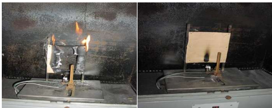
а б Рисунок 1 – Зразки гофрокартону після випробування: а – необроблений; б – оброблений
