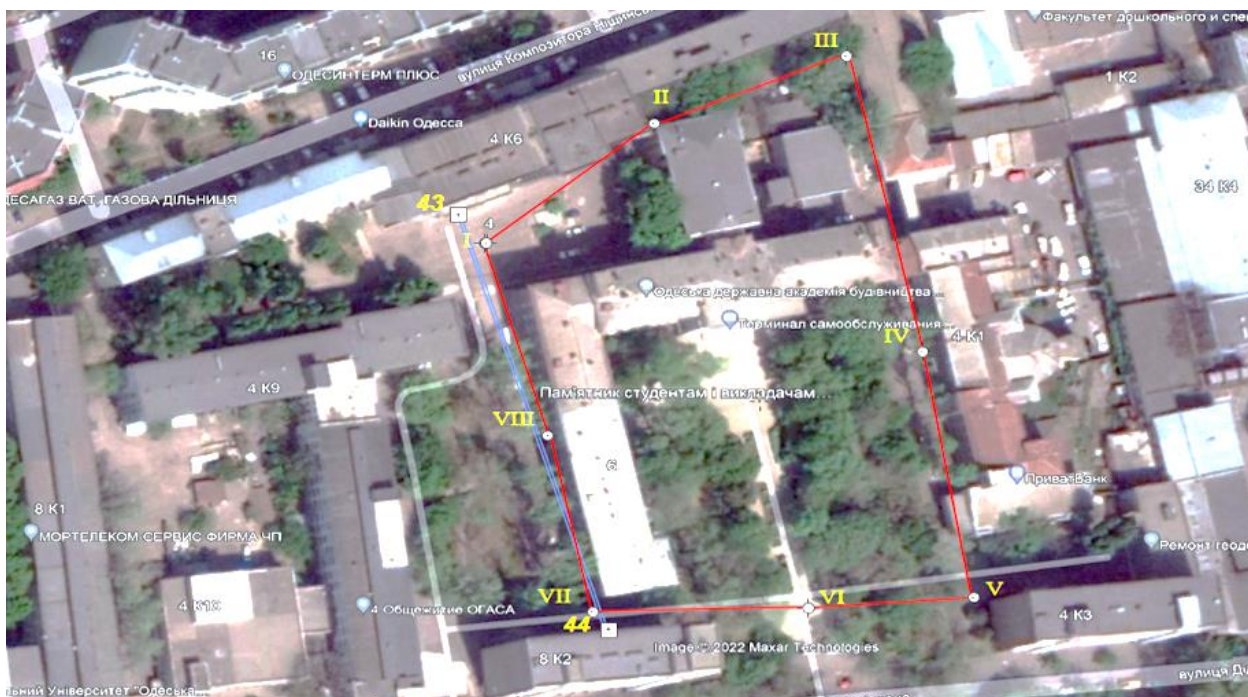
Рисунок 1. Один із типових варіантів теодолітного ходу
