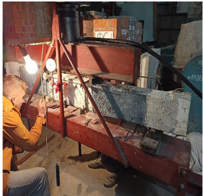
Рис. 7. Етап проведення експериментального дослідження дослідних зразків-балок
